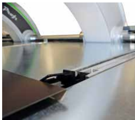
Alle Maschinen des Modells HKS-CS Profi haben einen Tiefenanschlag zur Verschiebung des Blechs.
