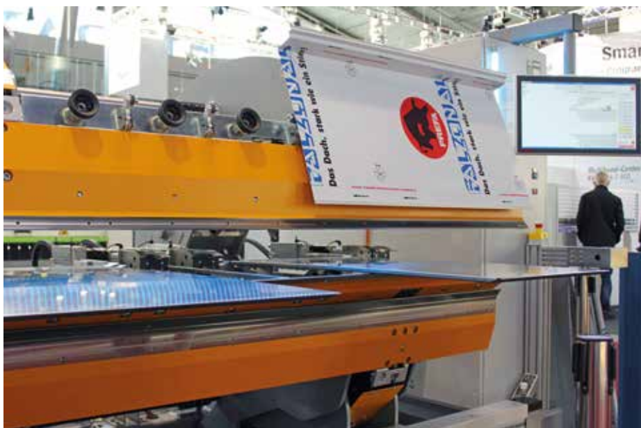
Automatisches wenden: Die automatische Blechwende-Einheit sorgt für eine hohe Reduzierung des Blechteile-Handlings und für flüssigere Biegeprozesse.
