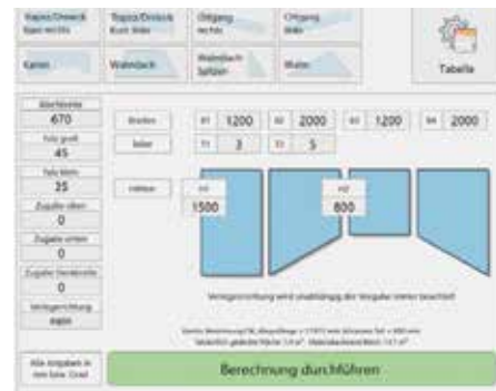
Auf der Maschine errechnet ein vorin- stalliertes Programm die Längen bzw. Schnittwinkel und gibt diese an die Steue- rung weiter.
