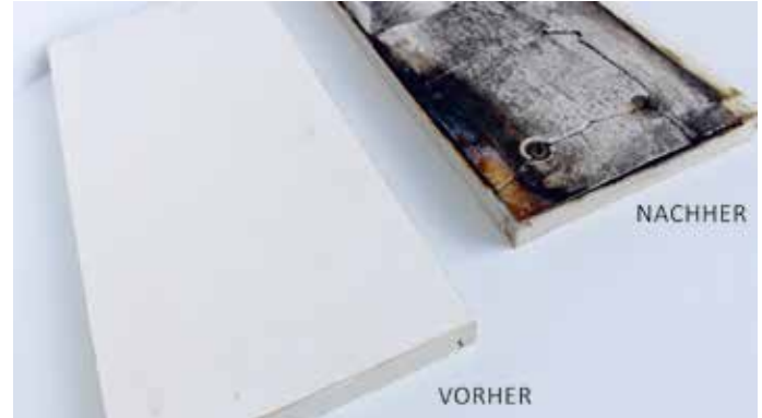
Die SF-Vakuumelemente Typ Firetherm wurden im Mai 2020 nach dem europäischen Brandverhalten EN 13501-1:2018 klassifiziert.
