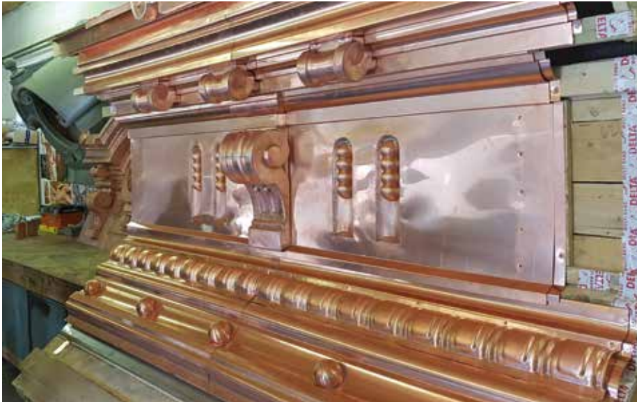
Die Ornamentelemente wurden am Dach aus geprägtem und gedruckten weichen Kupferblech hergestellt, die gezierten dünnwandigen Gussformstücke an den Fassaden wurden aus Zink produziert.
