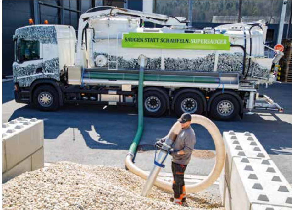
Die Supersauger der Münzer Bioindustrie GmbH sind Arbeitsmaschinen mit Hochleistungssauganlagen. Mit den am Fahrzeug angebrachten Spezialaufbauten können sowohl flüssige als auch trockene Materialien eingesaugt und auch verblasen werden.
