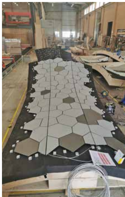
Bild 1 und 2: Anspruchsvolle Vorfabrikation der Einzelelemente und Montage der Einzelschuppen aus Zink in der Werkstatt. Bild 3: Beeindruckende Montage vor Ort in Rapperswil.
