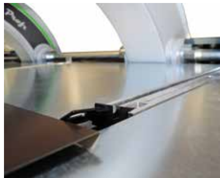
Alle Maschinen des Modells HKS-Cs Profi haben einen Tiefenanschlag zur Verschiebung des Blechs.
