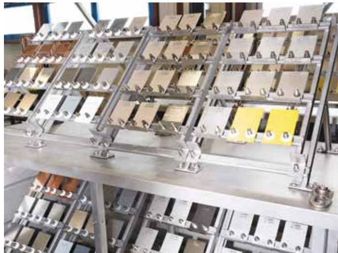
Die Unterlegscheiben aus MOSOTherm dienen der galvanischen Trennung zwischen den Verbindungsmitteln und den Blechen. Foto: Wilhelm Modersohn GmbH & Co. KG
