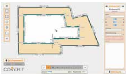
Zwei neue Funktionen von C|DAS 2 dargestellt: 1 die PENTHOUSE Funktion sowie 2 Planenbelegung und Bahnen-Verschneidungsberechnung – für eine praxiserprobte, effiziente Aufmaßerstellung am Flachdach.
