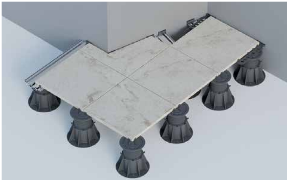
Randlösungen entlang der Wand bietet neu der VersiFrame E-Support, ein Aluminiumprofil mit 140mm Breite und 25mm Stärke, welches mit Gummischnüren für ein ruhiges Aufliegen versehen ist.
